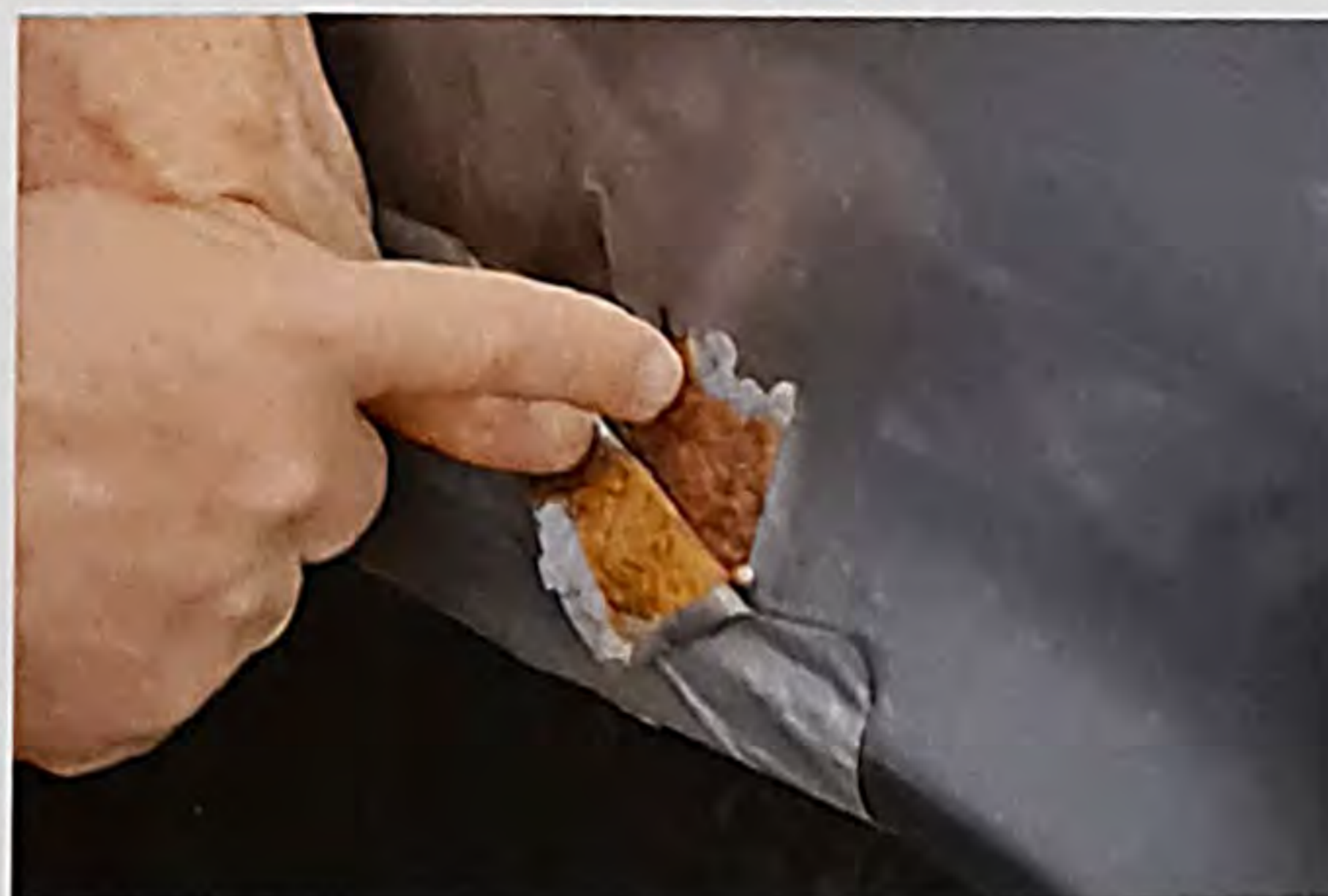
Der Audi ist ein attraktives Angebot. Leider hat er trotz Vollverzinkung heftige Rostwunden an beiden Kotflügeln, die Pflaster sind auch schon älter
